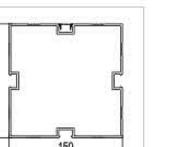
型号：150*150 名称：罗马立柱 重量：4.512kg/m 壁厚：2.5mm
