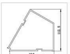
型号：GM-005 名称：135°转角 重量：3.027kg/m 壁厚：2.8mm
